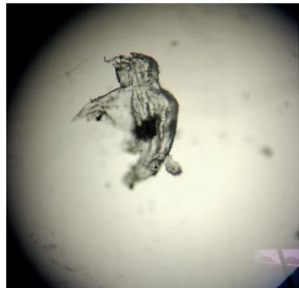
» Resultado positivo de elemento localizado bajo lupa (1) que se expone a fuente de calor y se observa bajo microscopio óptico (2 y 3). El elemento pasa a seleccionarse y localizarse para su análisis por infrarrojo (Fotos HyT).
