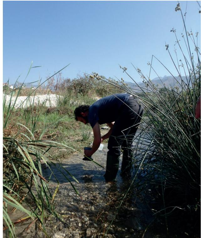
» Dependiendo del tramo, optaremos por muestrear de forma indirecta (puente, en la imagen izquierda) o directa (sobre el cauce, en la imagen derecha).
